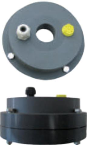
**TESTE DI CHIUSURA POZZO IN PVC** con foro centrale tappino e passacavo. Le teste sono composte da una flangia ed una contro flangia che vengono accoppiate e serrate con viti e bulloni e sono utilizzate per assicurare la protezione del pozzo da possibili contaminazioni.
