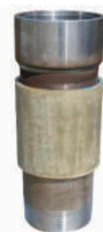
■ ■ ■ **GIUNTO DIELETTRICO**. Fondamentale per assicurare l'isolamento elettrico permanente tra un materiale e l'altro quando la colonna è composta da tubi di materiali diversi (es. acciaio inox e acciaio al carbonio), il giunto dielettrico inoltre protegge la parte di colonna a valle da eventuali correnti vaganti.
