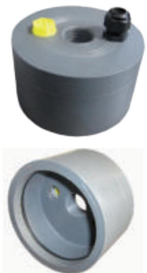
**TESTE DI CHIUSURA POZZO IN PVC** a pressione con foro centrale tappino e passacavo. Rispetto alle normali teste di chiusura del pozzo hanno un prezzo inferiore e sono più veloci da applicare poiché non hanno viti e bulloni, l'isolamento del pozzo dall'ambiente esterno è comunque garantito da una guarnizione in gomma (o-ring) posizionata all'interno.
