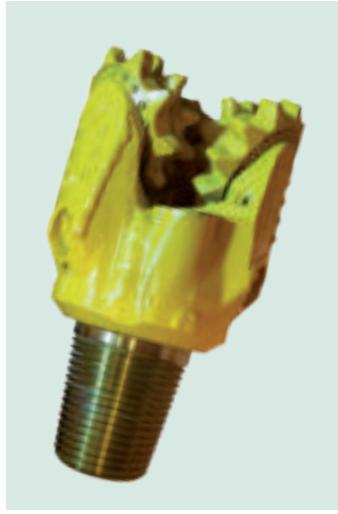
Il **TRICONO** è composto da tre rulli conici muniti di denti d'acciaio, rullo o sfera in carburo di tungsteno. Il più comune è il tricono con denti in acciaio corti o lunghi per il terreno morbido o medio i triconi in carburo di tungsteno per terreni semiduri o resistenti come la roccia. Il Tricono può essere acquistato nuovo o usato.
