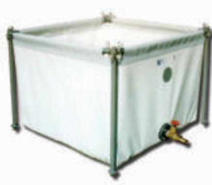
**SERBATOIO FLESSIBILE PER IL CONTENIMENTO DI LIQUIDI**, costituito da una sacca in tessuto poliestere extraforte rivestita con plastomeri, sostenuta da un telaio metallico di facile assemblaggio. Capacità da 1m<sup>3</sup> a 60 m<sup>3</sup> (in base alle dimensioni, vedi tabella sotto). Quando non utilizzato il serbatoio può essere ripiegato e ridotto ad un minimo ingombro.
